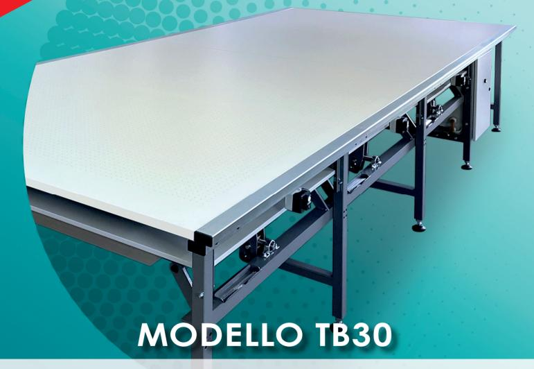
I nostri tavoli ad aghi sono progettati e costruiti interamente in Italia utilizzando materiali e rifiniture di qualità. La robusta struttura è realizzata con tubolare di acciaio verniciato a forno, mentre i binari di scorrimento sono in acciaio zincato. I piani di lavoro, di spessore 25mm, sono realizzati in binobilitato interamente bordato, mentre la griglia di alloggiamento degli aghi viene realizzata con foratura al laser che garantisce
